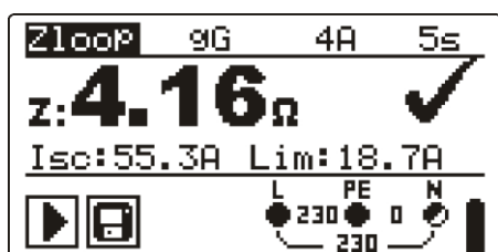
Bild 5.25: Beispiele für Messergebnisse der Schleifenimpedanz
