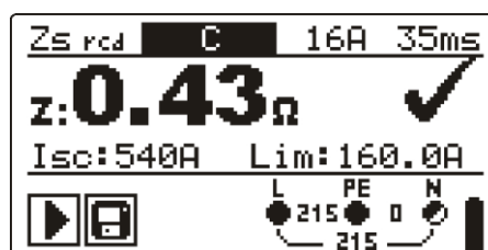
Bild 5.25: Beispiele für Messergebnisse der Schleifenimpedanz
