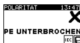
Bild 5.22: Beispiele für Polaritätsprüfungs-Ergebnisse
