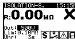
Bild 5.13: Beispiele von Ergebnissen der Isolationswiderstandsmessung-S
