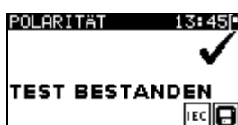
Bild 5.22: Beispiele für Polaritätsprüfungs-Ergebnisse
