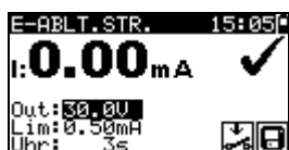
Bild 5.16: Beispiele von Ergebnissen der Messung des Ersatzableitstroms
