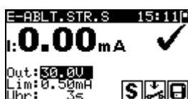
Bild 5.19: Beispiele von Ergebnissen der Messung des Ersatzableitstroms-S
