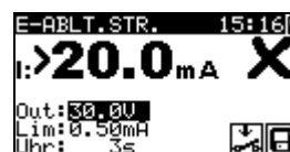
Bild 5.16: Beispiele von Ergebnissen der Messung des Ersatzableitstroms
