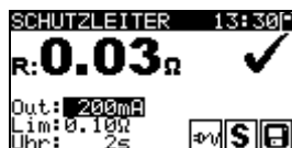
Bild 5.7: Beispiele von Ergebnissen der Schutzleiterwiderstand-Durchgangswiderstandsmessung
