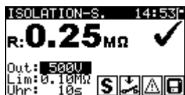
Bild 5.13: Beispiele von Ergebnissen der Isolationswiderstandsmessung-S
