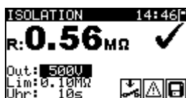
Bild 5.10: Beispiele von Ergebnissen der Isolationswiderstandsmessung
