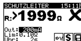
Bild 5.7: Beispiele von Ergebnissen der Schutzleiterwiderstand-Durchgangswiderstandsmessung
