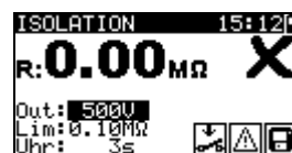
Bild 5.10: Beispiele von Ergebnissen der Isolationswiderstandsmessung
